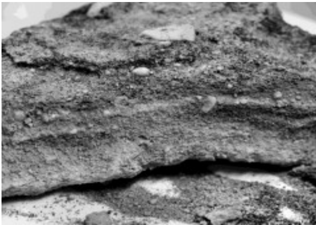
Bodemmonster van de waterkerende laag. De eigenlijke waterscheiding komt voor rekening van de licht gekleurde en slechts enkele centimeters dunne laag die van links naar rechts midden door het fragment loopt. Foto J. Meijer.
